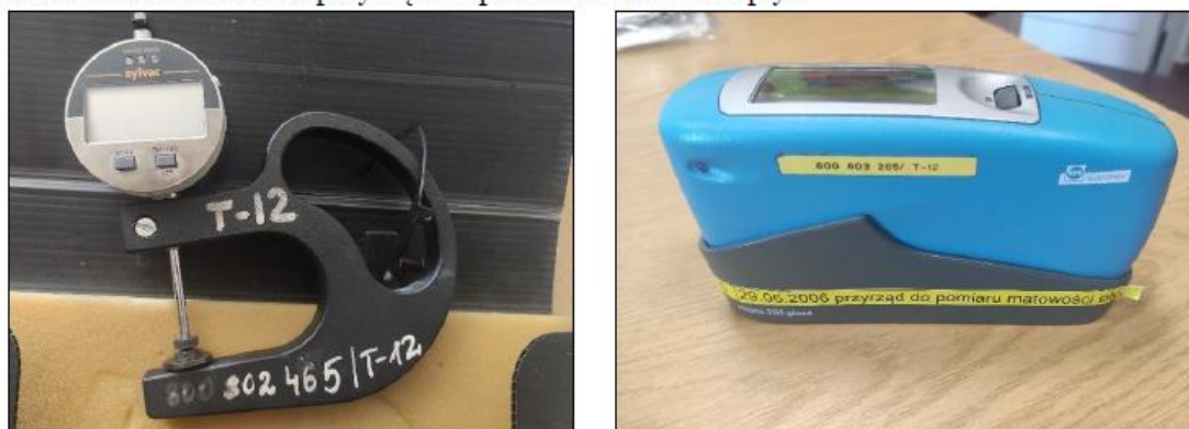
Fot. Grubościomierze i przyrząd do pomiaru matowości płyt
